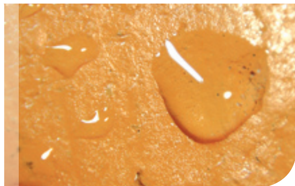
effet perlant du revêtement Provalfuge
